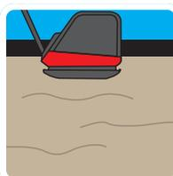
Шаг 2: Укладка песка. Минимальный слой песка должен составлять 5 см. Распределите песок между двумя бордюрами. Распределите песок равномерно и уплотните вибрационной пластиной.
